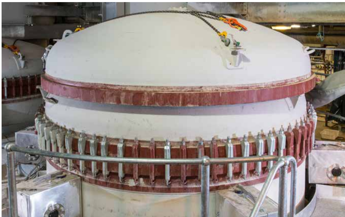
The filter vessel lids of the segment filters can be placed on top of each other to save space. Les couvercles des filtres à segments peuvent être placés l'un au-dessus de l'autre pour gagner de la place. Las tapas de los filtros de segmentos pueden colocarse una encima de la otra para ahorrar espacio.
